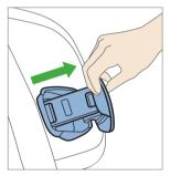
사고 발생시 안전도를 개선하려면 유아용 카시트의 측면 충격 보호장치를 작동시키십시오. 이를 위해서 는 유아용 카시트의 차문 방향 측면에 위치한 충격 보호장치를 들어올립니다. 충격 보호장치에 힘을 가 해서, 제자리에 고정되었는지 확인하십시오.
